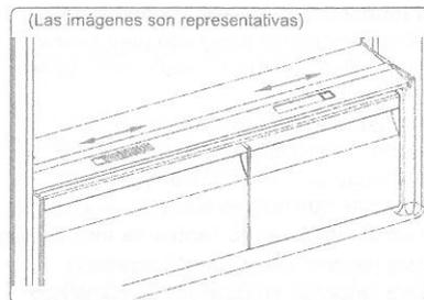
Si el cajón para fruta y verdura está lleno, el indicador de frescura ubicado en la parte frontal del cajón debe dejarse abierto. De este modo se controla el aire y la humedad que hay dentro del cajón para aumentar la vida de los alimentos que haya en su interior.
