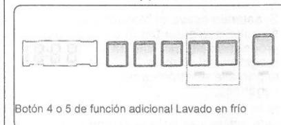
Puede determinar que el programa de lavado seleccionado utilice agua fría mediante el uso de esta función adicional.
