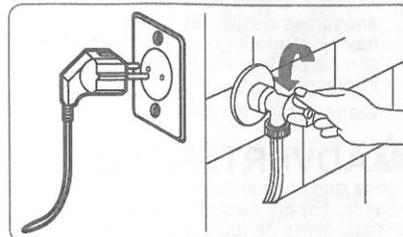
Apague la lavadora y desconecte el enchufe de la toma eléctrica antes de llevar a cabo tareas de mantenimiento y limpieza en la máquina.
