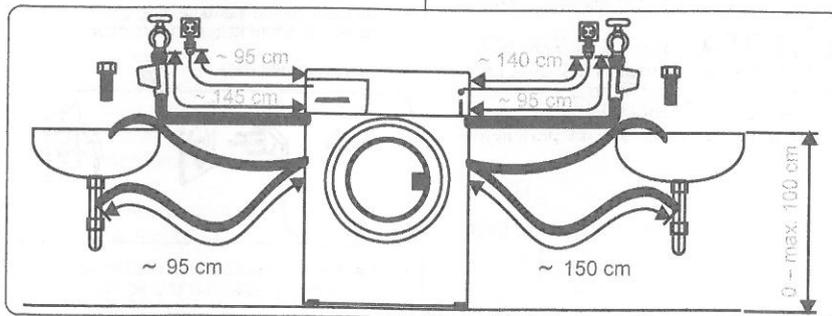
**NOTA:** La lavadora solo debe conectarse al suministro de agua mediante la nueva manguera de llenado proporcionada. No se deben reutilizar mangueras antiguas.
