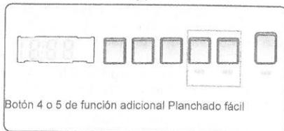
Si utiliza esta función, la ropa tendrá menos arrugas cuando termine el programa de lavado que haya seleccionado. Para seleccionar esta función, pulse el botón Planchado fácil cuando se muestre el símbolo.
