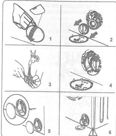
El sistema de filtro de bomba de la lavadora alarga la vida de la bomba al impedir que entren pelusas en la máquina.
