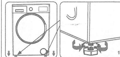
1. No instale la máquina sobre una superficie (como, por ejemplo, una alfombra) que impida la ventilación de la base.
