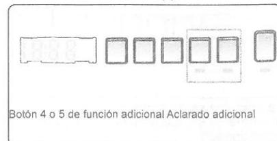
Puede añadir una operación de aclarado adicional al final del programa de lavado seleccionado mediante el uso de esta función adicional.
