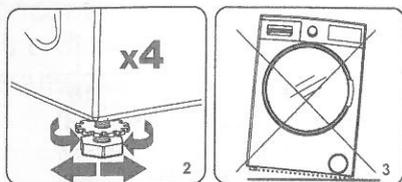
2. Para aumentar la altura de la máquina, gire la pata en el sentido de las agujas del reloj. Para reducir la altura de la máquina, gire la pata en el sentido contrario al de las agujas del reloj.
