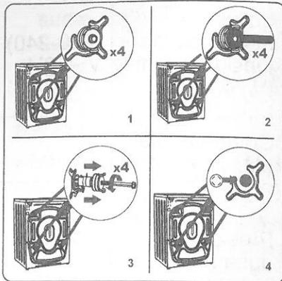
1. Antes de usar la lavadora, quite los cuatro pernos de transporte y los separadores de goma de la parte trasera de la máquina. Si no se quitan los pernos, la garantía podría quedar anulada y podrían producirse fuertes vibraciones, ruido y el funcionamiento defectuoso de la máquina.
