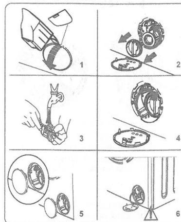
El sistema de filtro de bomba de la lavadora alarga la vida de la bomba al impedir que entren pelusas en la máquina.
