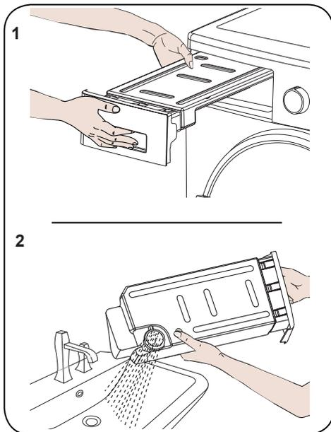
1. Tire de la cubierta del cajón y saque el depósito con cuidado.
