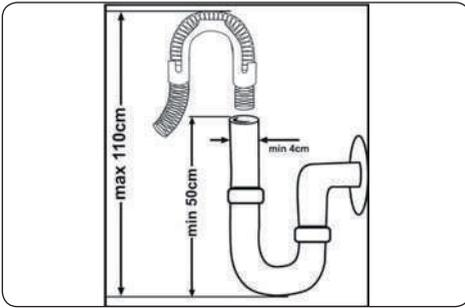
Conecte el tubo de desagüe de agua directamente en el agujero de desagüe o en el grifo de salida del fregadero. Esta conexión debe estar como mínimo a 50 cm y como máximo a 110 cm del plano del suelo.
